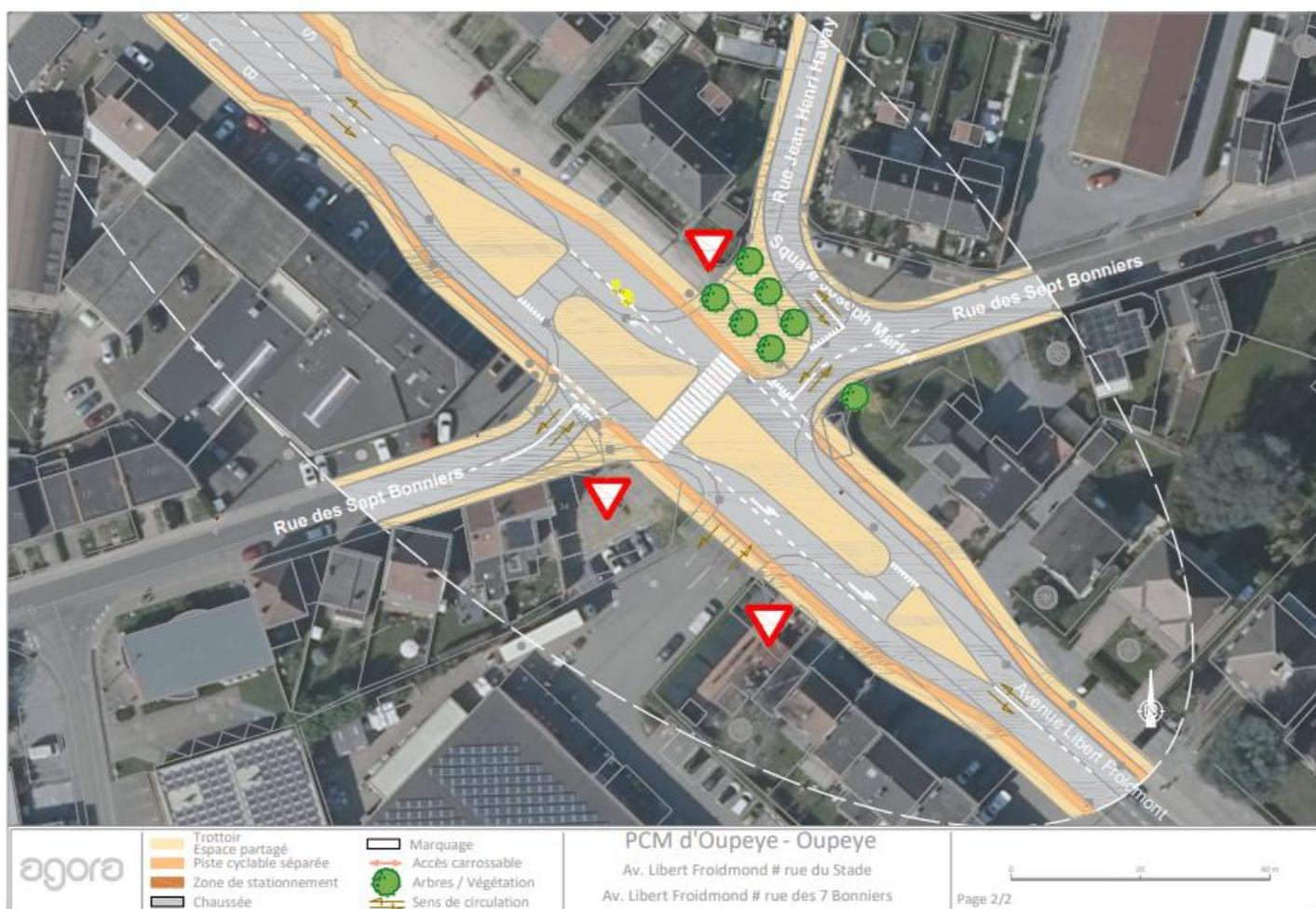
Figure 71 : recherche de rupture de vitesse et sécurisation des traversées - source : Agora
