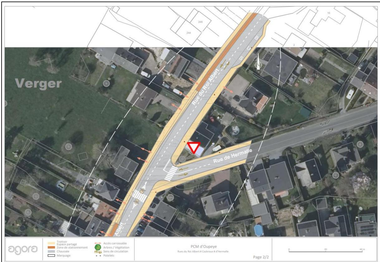
Figure 73 : variante 1 axée sur le carrefour avec effet de porte et dévoiement - source : Agora
