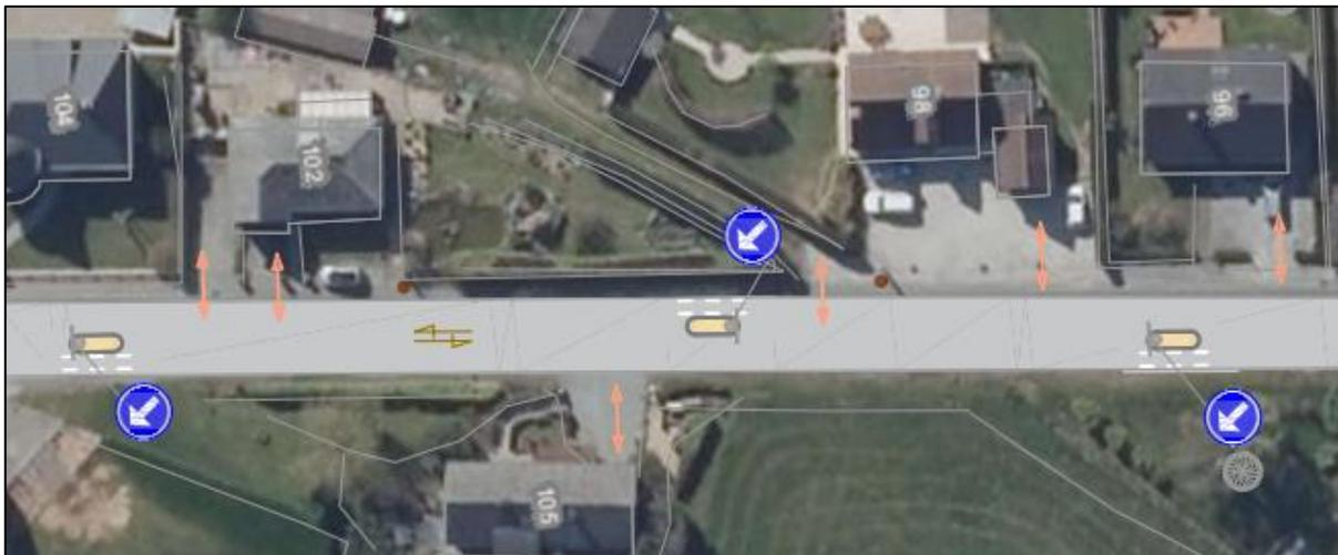
Figure 58 : Exemple de chicane avec bordures collées et passage latéral cycliste
