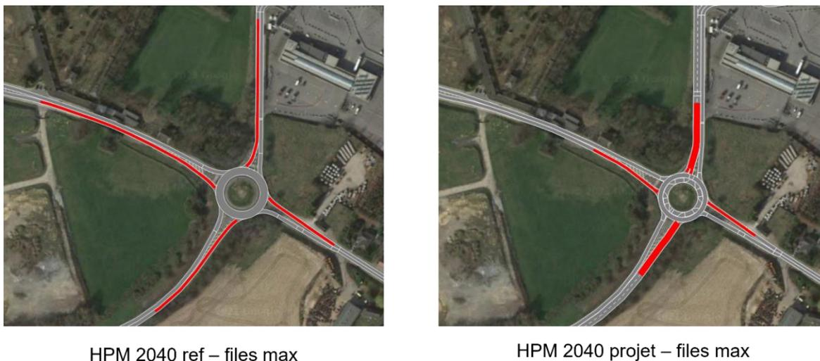
*Figure 39 : Files maximales au rond-point Valise, selon le modèle de microsimulation (Vissim)*
