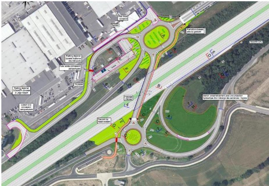
Figure 6 : Réaménagement de l'échangeur n°3 Aéroport
