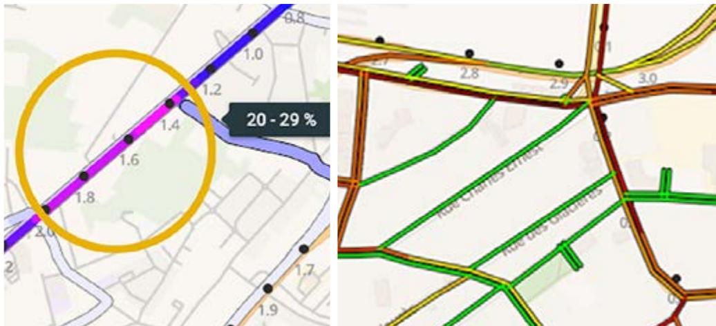
Q FCD : analyse de la répartition des flux et des vitesses pratiquées. Source : flowcheck.be-mobile.biz
