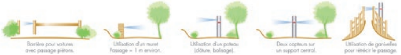
Exemples d'implantation des capteurs pyroélectriques. Source : Eco compteur.
