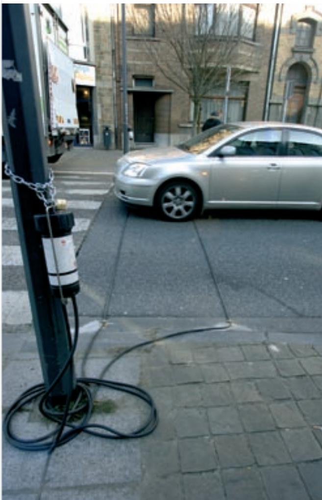
Compteur pneumatique. Source : MET - D434.
