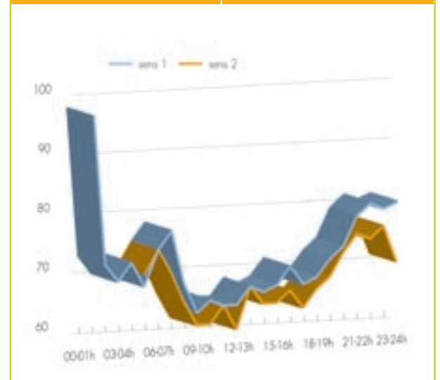
Liège, N240 – Thisnes-Hannut centre : répartition des vitesses moyennes par sens et par heure. Source : MET – Direction générale des autoroutes et des routes.
