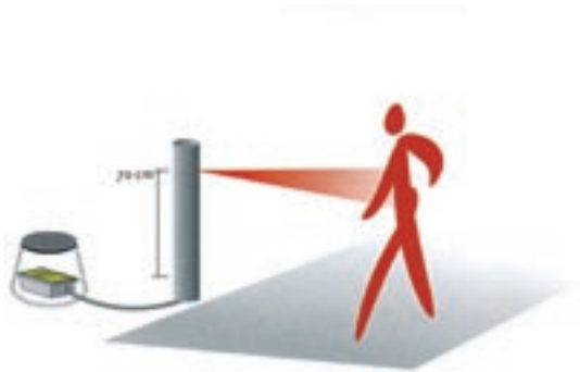
Capteur pyroélectrique. Source : Eco compteur.
