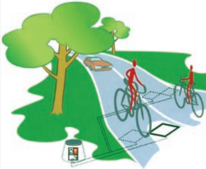
Capteur boucles magnétiques pour vélo. Source : Eco compteur.
