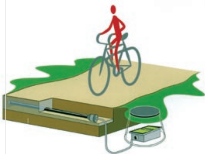
Capteur tube hydroacoustique. Source : Eco compteur.
