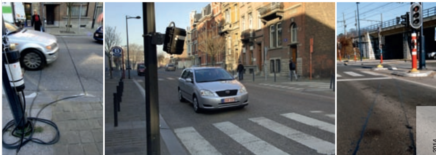
De gauche à droite : compteur pneumatique, compteur radar, compteur boucle fixe électromagnétique. Source : SPW – Direction de l'Édition.
