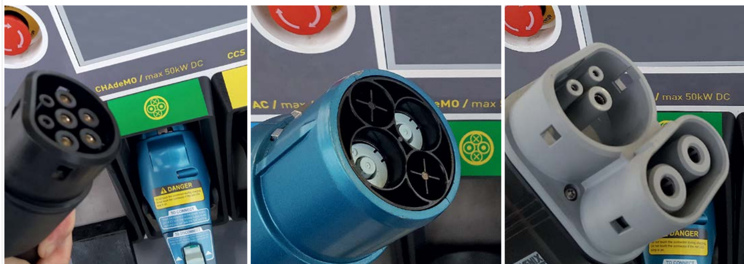
Types de recharge : Type2 monophasé et triphasé, type4 rapide monophasé, type2 "Combo" rapide. Source : blue2bgreen.com
