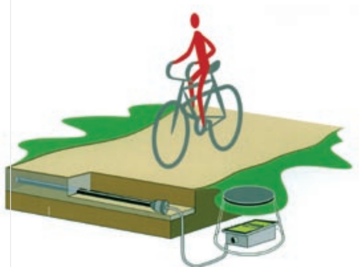
Capteur tube hydroacoustique. Source : Eco compteur.
