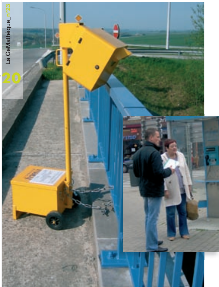
Lecteur autonome de plaques; enquêtes. Sources : MET – D434, Direction générale des autoroutes et des routes.
