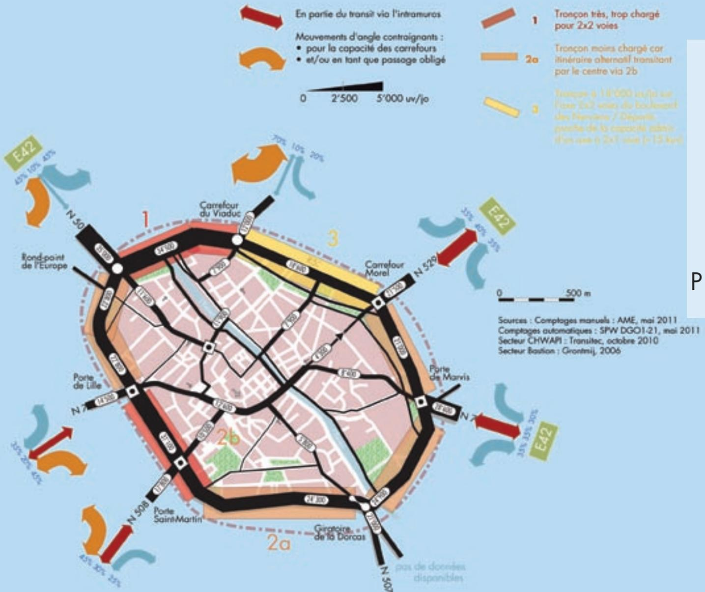
Tournai : charges de trafic journalières, détails d'éclatement des flux sur les portes d'entrées et capacités utilisées en section (HPM, HPS) – Etat 2011. Source : Transitec – PCM Tournai.
