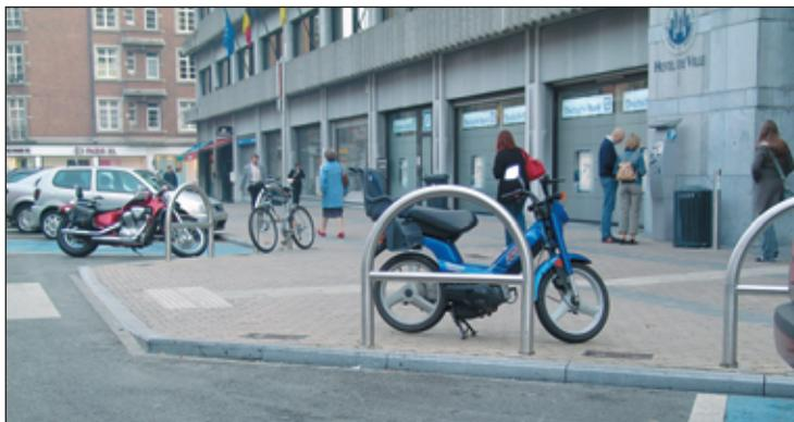
Figure 2: les avancées de trottoir, un type d'aménagement préconisé pour sécuriser la traversée des piétons. © MET-D 434 (n° 05/5288)
