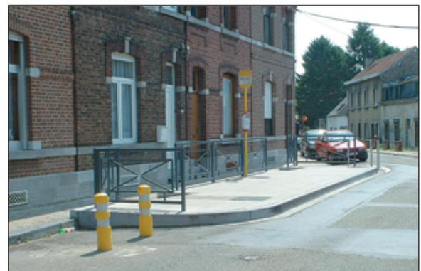
Figures 3 et 4: l'arrêt de bus de type « quai », avec avancée de trottoir. © GAMAH
