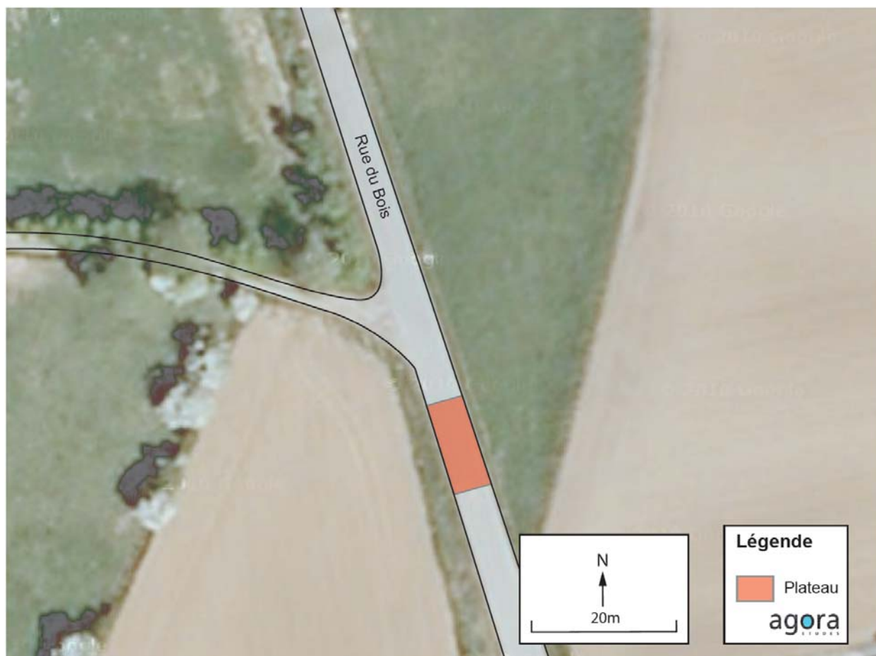
Aménagement d'un plateau dans le rue du Bois
