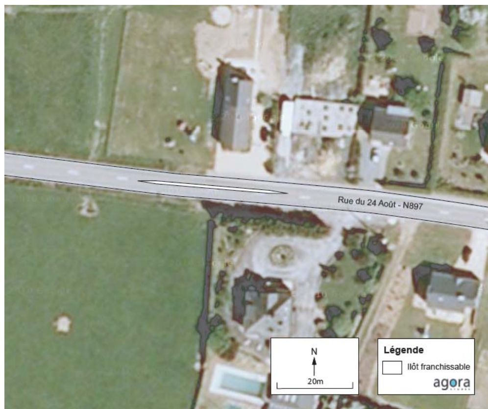
Effet de porte le long de la rue du 24 Août
