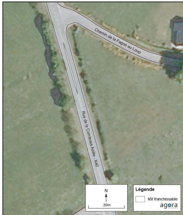
Effet de porte le long de la N40 au niveau de l'intersection avec le chemin de la Fagne au Loup
