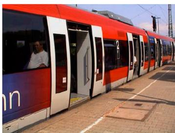
Bon nombre de nos voisins européens bénéficient d'un matériel ferroviaire moderne. En Allemagne, le Talent de Bombardier dispose de larges portes bien réparties, à doubles battants et d'un accès aisé. © ACTP
