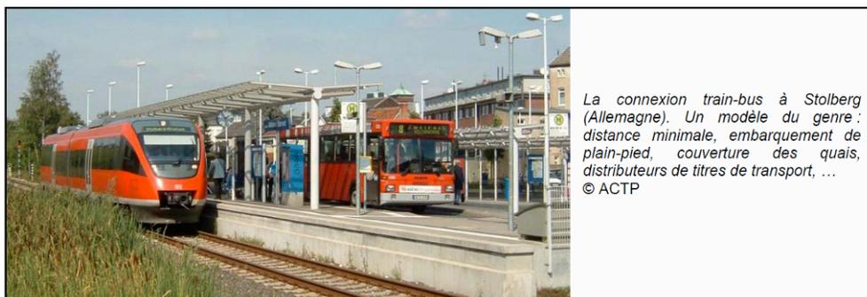
La connexion train-bus à Stolberg (Allemagne). Un modèle du genre : distance minimale, embarquement de plain-pied, couverture des quais, distributeurs de titres de transport, ...
