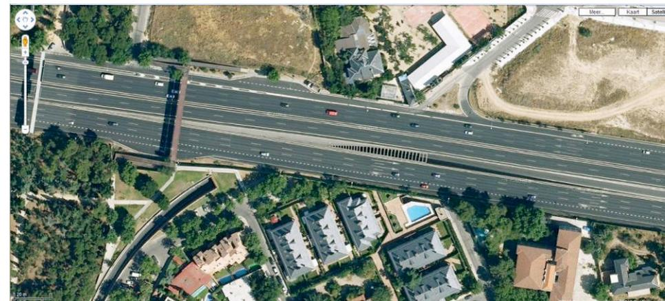
**Figure 4 : Madrid : insertion des bus au centre de l'autoroute par passage inférieur (source : Google Earth)**
