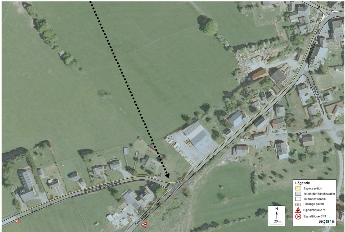
**Avenue du Cdt de Laage de Meux (N808) : Trottoir proposé côté sud dans la continuité du trottoir existant et aménagement d'une chicane pour ralentir les véhicules, réaménagement du carrefour avec la rue de la Justice en élargissement des oreilles de trottoir**
