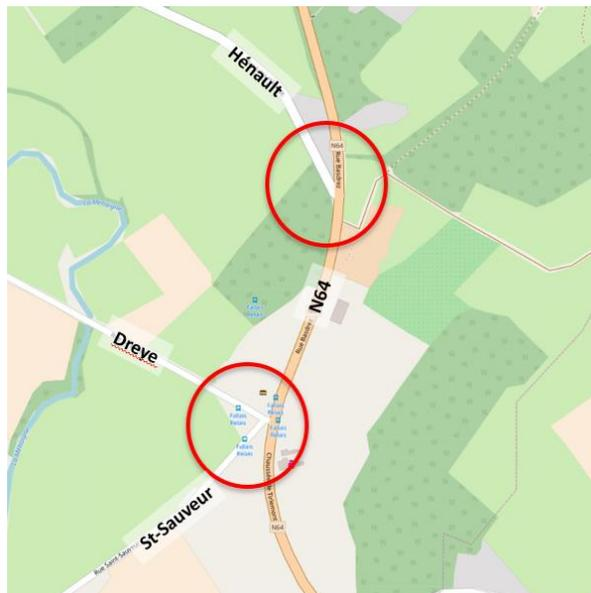
1/ Les véhicules en provenance de la rue Jules Hénault disposent d'une mauvaise visibilité vers le nord rendant les mouvements d'insertion sur la N64 dangereux, notamment en mouvement de tourne-à-gauche. Pour rappel, la circulation y est limitée à 70 km/h sur ce tronçon.
