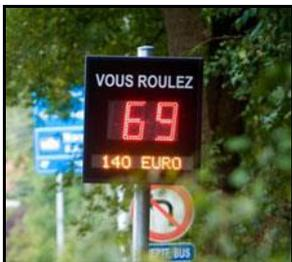
Le radar peut être fixe, ou mobile afin de le déplacer régulièrement sur la commune. A noter que de nombreux modèles fonctionnent à l'énergie solaire, ce qui facilite son installation.
