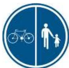
Sur le tronçon du chemin de Fontaine-L'Évêque, entre la A54 et le R24, une piste cyclo-piétonne bidirectionnelle (D9) séparée et sécurisée sera prévue le long de la voirie. La limitation de vitesse du tronçon sera maintenue à 70 km/h, mais elle sera réduite à 50km/h à l'approche des carrefours et des arrêts de bus.
