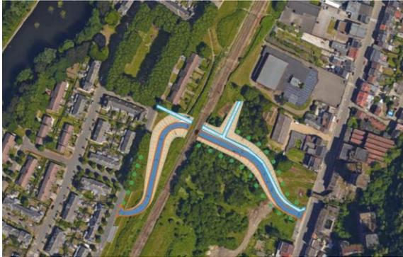
Figure 103. Création d'un nouvel ouvrage comportant un passage routier et un couloir sous voies
