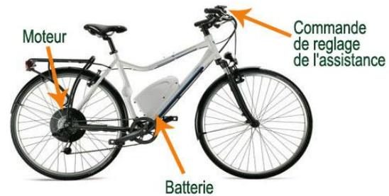
Figure 45. Eléments du fonctionnement du VAE
