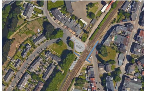
Figure 104. Suppression du PN 16 situé rue Joseph Lhoest et la création d'un couloir sous voies et d'une aire de rebroussement
