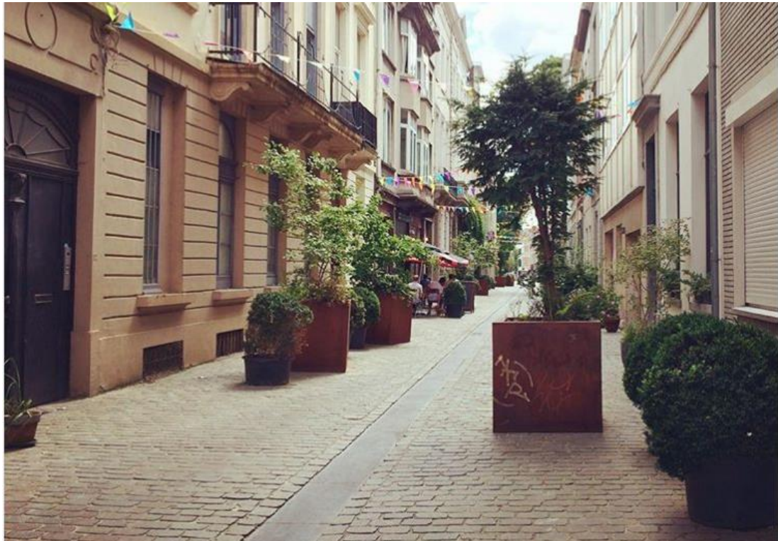
Figure 22 : Rue Keyenveld à Ixelles – Trois rues sont réaménagées en "zone de rencontre" : la vitesse des véhicules est limitée à 20 km/h, les piétons sont prioritaires, le revêtement est constitué de pavés gris plats, sur un seul niveau (sans trottoirs), de façade à façade, avec une légère déclivité centrale. Photo : Tractebel 2017
