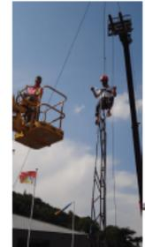
Au départ d'un simple vélo de type Beach Cruiser, notre atelier soudure a assemblé une structure métallique permettant d'atteindre la hauteur voulue. Les 6,15 mètres atteints, la réflexion de nos mécaniciens s'est portée sur le dernier étage du vélo, la motricité et la stabilité de celui-ci.
