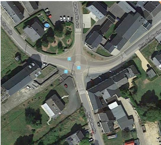
Ce large carrefour, récemment aménagé, incite au ralentissement en raison du changement de revêtement. La forme circulaire dessinée par les pavés de teintes différentes engendre une confusion quant à fonctionnement du carrefour. Il s'agit en effet d'un carrefour à priorité de droite et non un rond-point.
