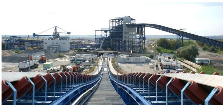
Figure 49 : Exemple de bandes transporteuses
